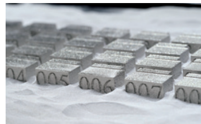
パウダーベッドタイプによる試作造形の模様
