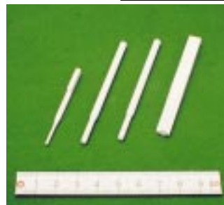
図2 Cuリードフレーム打ち抜き用ジルコニア工具 Fig. 2 Zirconia tool for blanking Cu leadframe
