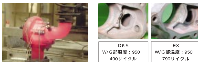
図3 排気シミュレータによる耐久試験条件と試験結果
