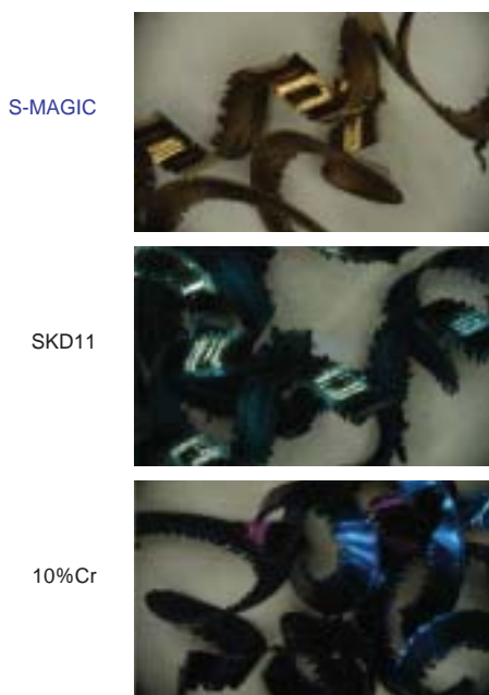
図12 フライステストで得られた切り粉の外観写真 Fig. 12 Observation of chips after face milling test.
