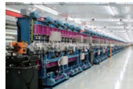
SACLA に使われた NEOMAX エンジニアリング(株)製 真空封止アンジュレータ
