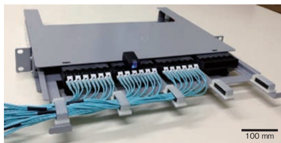
図11 19インチラック用通信光可視化モジュール Fig. 11 Module of visual connection identifier (19-inch)
