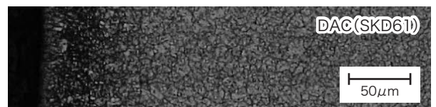
ガス軟窒化処理後の表層の断面マイクロ写真
