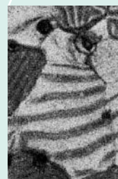
フェライト磁区観察 イメージ図 Image of Magnetic Domain in Sintered Ferrite
